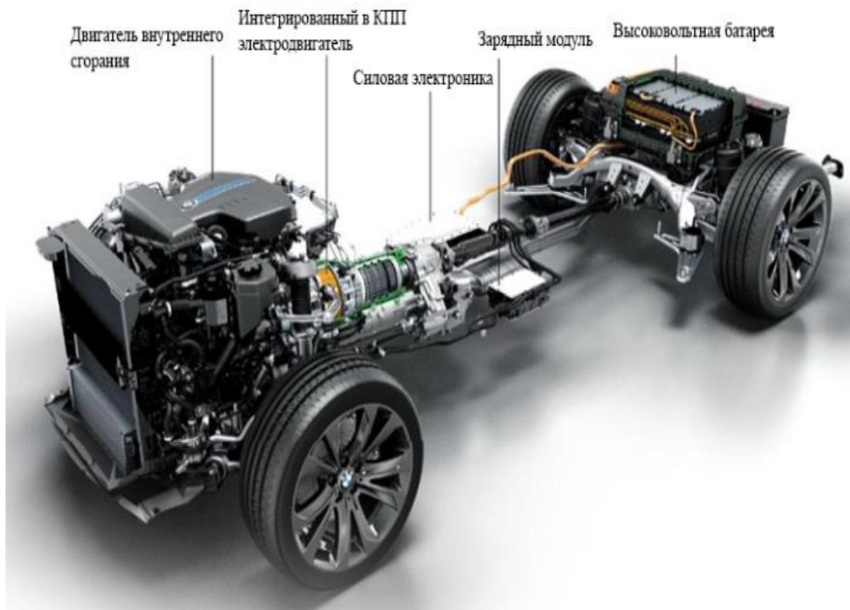
**Рис. 1. Общее устройство системы BMW eDrive
